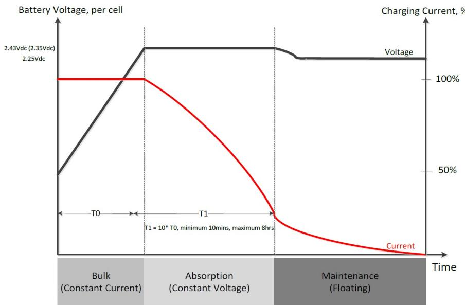
Punjač poseduje tri nivoa punjenja baterija i to "bulk" (punjenje konstantnom strujom), "absorption" (apsorpcija - punjenje sa konstantnim naponom) i "floating" (plivajući režim - održavanje). Pored toga, invertor dozvoljava podešavanje raznih parametara kao što su nivoi napona punjenja baterija, prioriteti izvora punjenja, nizak napon isključenja potrošača, prelazak na mrežni izvor. Zahvaljujući tome, sistem može da radi u najoptimalnijim uslovima što je preduslov za dug životni vek sistema.
